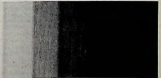
Afb. 41. Proefstrook, opgenomen bij trapsgewijs opgevoerde stroomsterkte. De stroomsterkte bedroeg bij de witte band 6 mA, bij de zwarte band 22 mA. Het verschil tussen twee opeenvolgende banden bedroeg 2 mA. (zie tekst). Lichtbron R1130B; Agfa Bovira BN111, ontw. Duotol, toerental beeldtrommel 240 omw/min, diameter beeldtrommel 70 mm.
