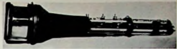
Kathodestraalbuis met microkanalenplaat.
